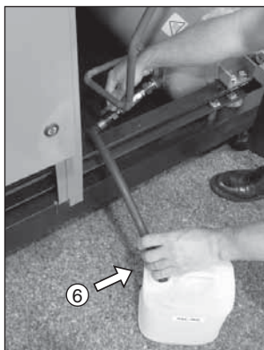
Рис. 6.8: Слить старое масло и ресивера сж.воздуха и масла
